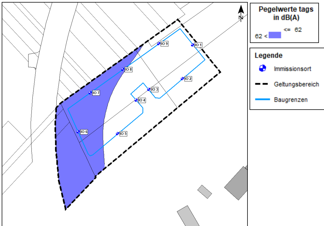
Abb. 5.2-3: Bereiche > 62 dB(A) tags, Rechenhöhe 8 m ü. Gelände
