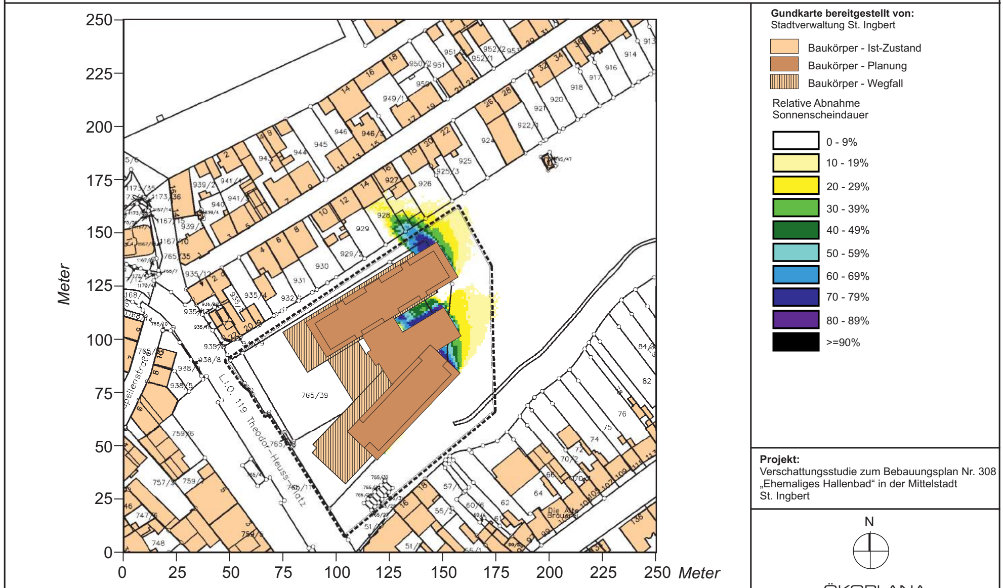
Abb. 15.1 Vorher-Nachher-Vergleich. Planungsbedingte relative Abnahme der max. möglichen mittleren Sonnenscheindauer im Zeitraum Dezember - Februar / klare Wintertag. Bezugshöhe 2 m ü.G. (~ EG)
