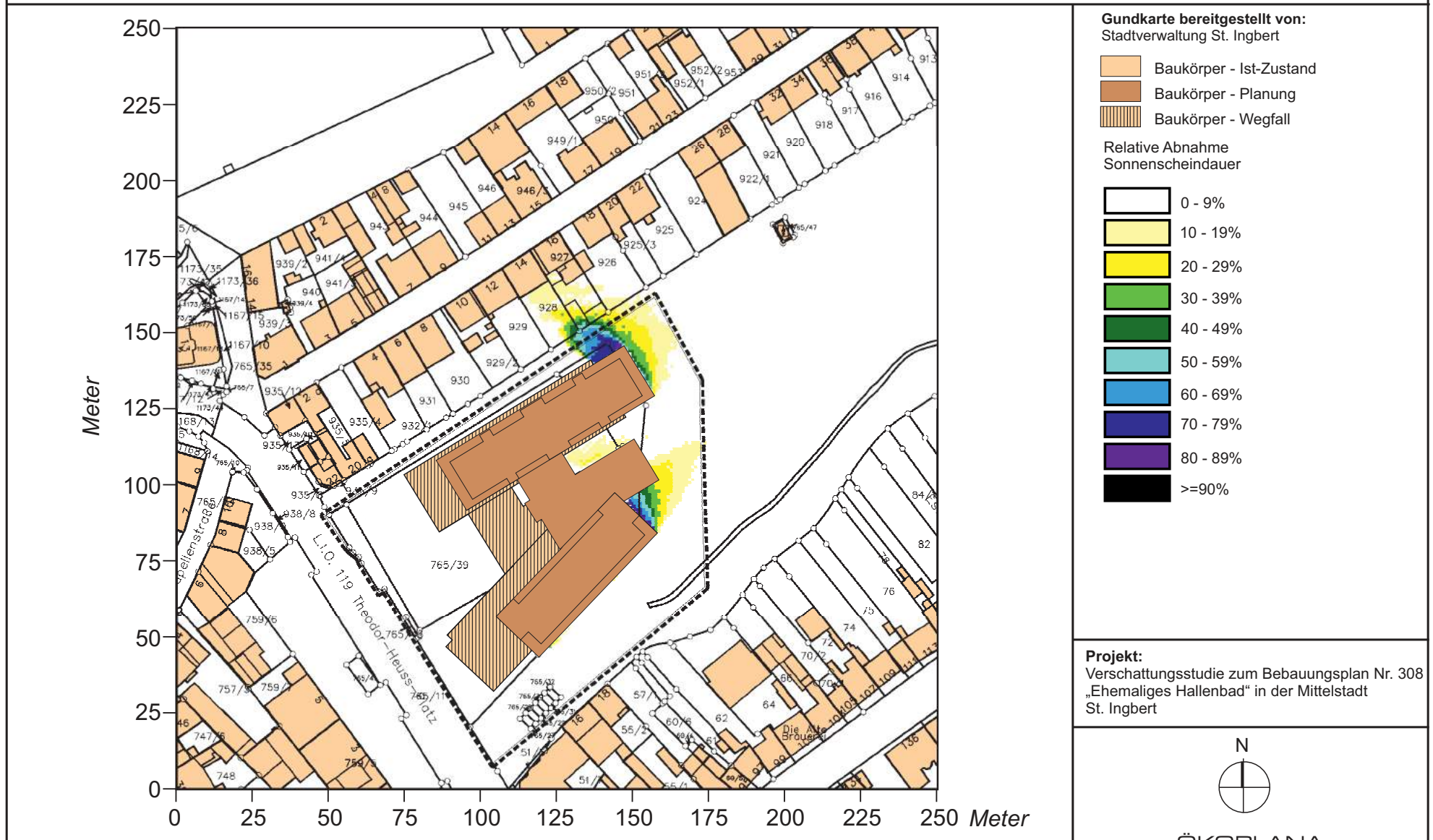
Abb. 15.2 Vorher-Nachher-Vergleich. Planungsbedingte relative Abnahme der max. möglichen mittleren Sonnenscheindauer im Zeitraum Dezember - Februar / klare Wintertag. Bezugshöhe 5 m ü.G. (~ 1. OG)
