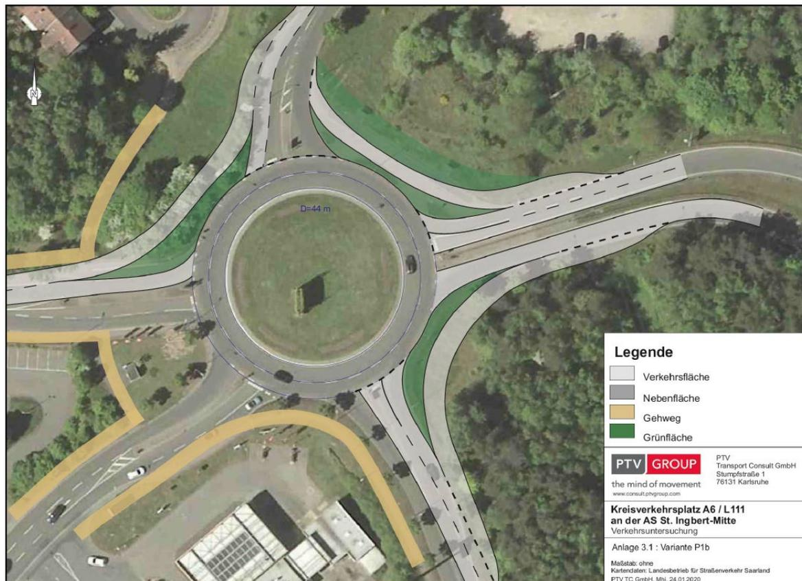
Abbildung 2: Vorzugsvariante P1b-3BP zum Umbau des Kreisverkehrs A6/L111
