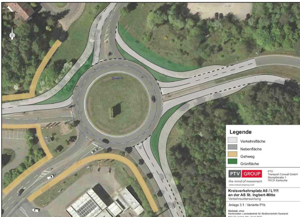
Vorzugsvariante P1b-3BP zum Umbau des Kreisverkehrs A 6/L 111, Quelle PTV Transport Consult GmbH: Verkehrsuntersuchung ..., Abbildung 2, S. 5
