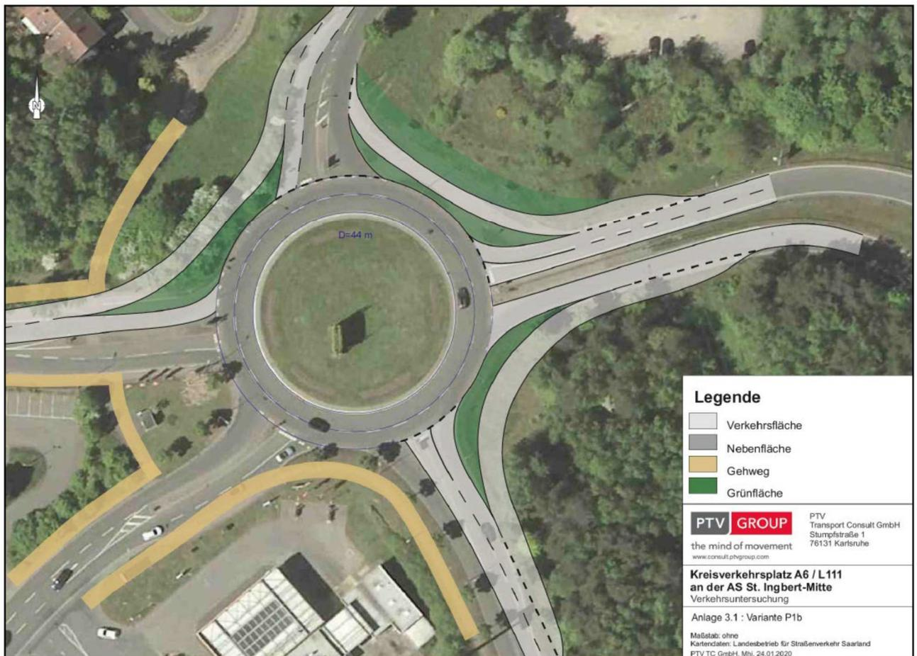
Vorzugsvariante P1b-3BP zum Umbau des Kreisverkehrs A 6/L 111, Quelle PTV Transport Consult GmbH: Verkehrsuntersuchung ..., Abbildung 2, S. 5
