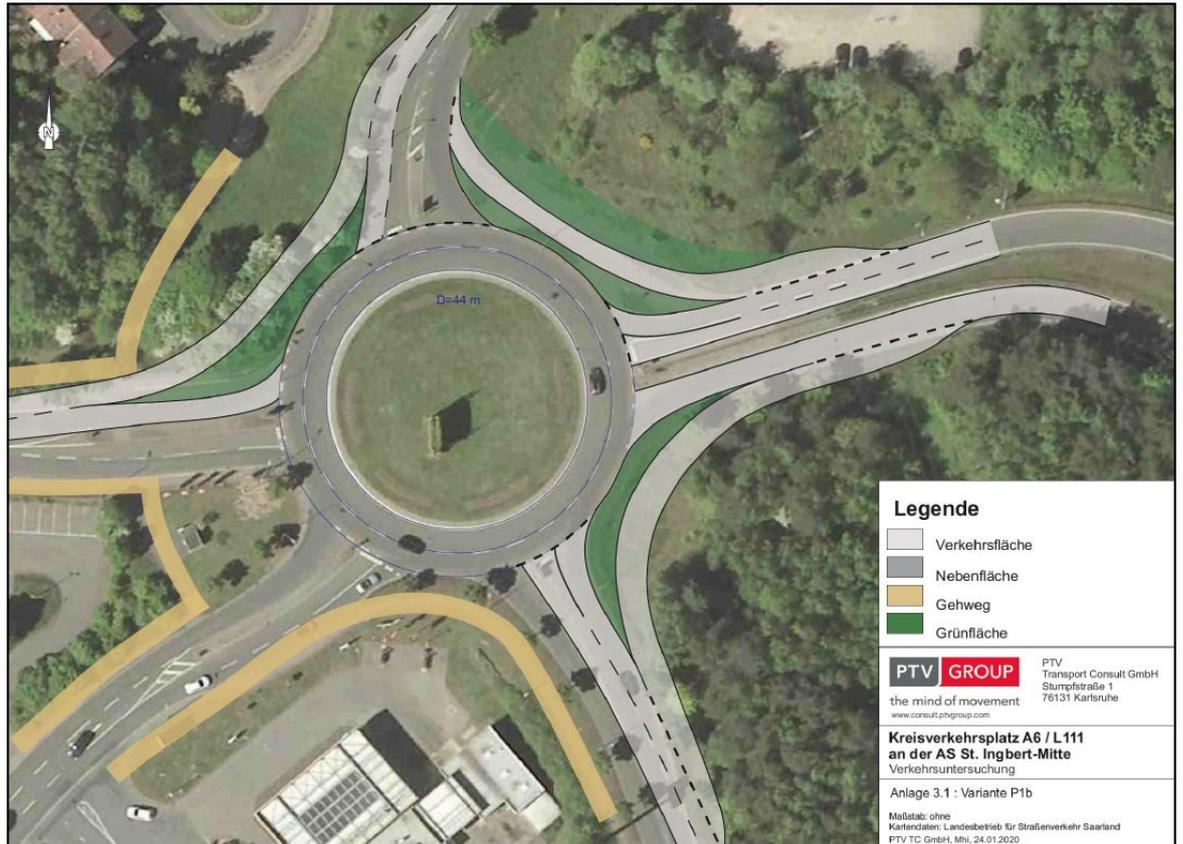
Abbildung 2: Vorzugsvariante P1b-3BP zum Umbau des Kreisverkehrs A6/L111
