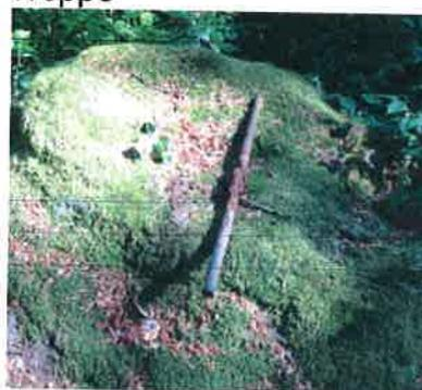
Foto 21 Rundeisen von defekter Treppenstufe
