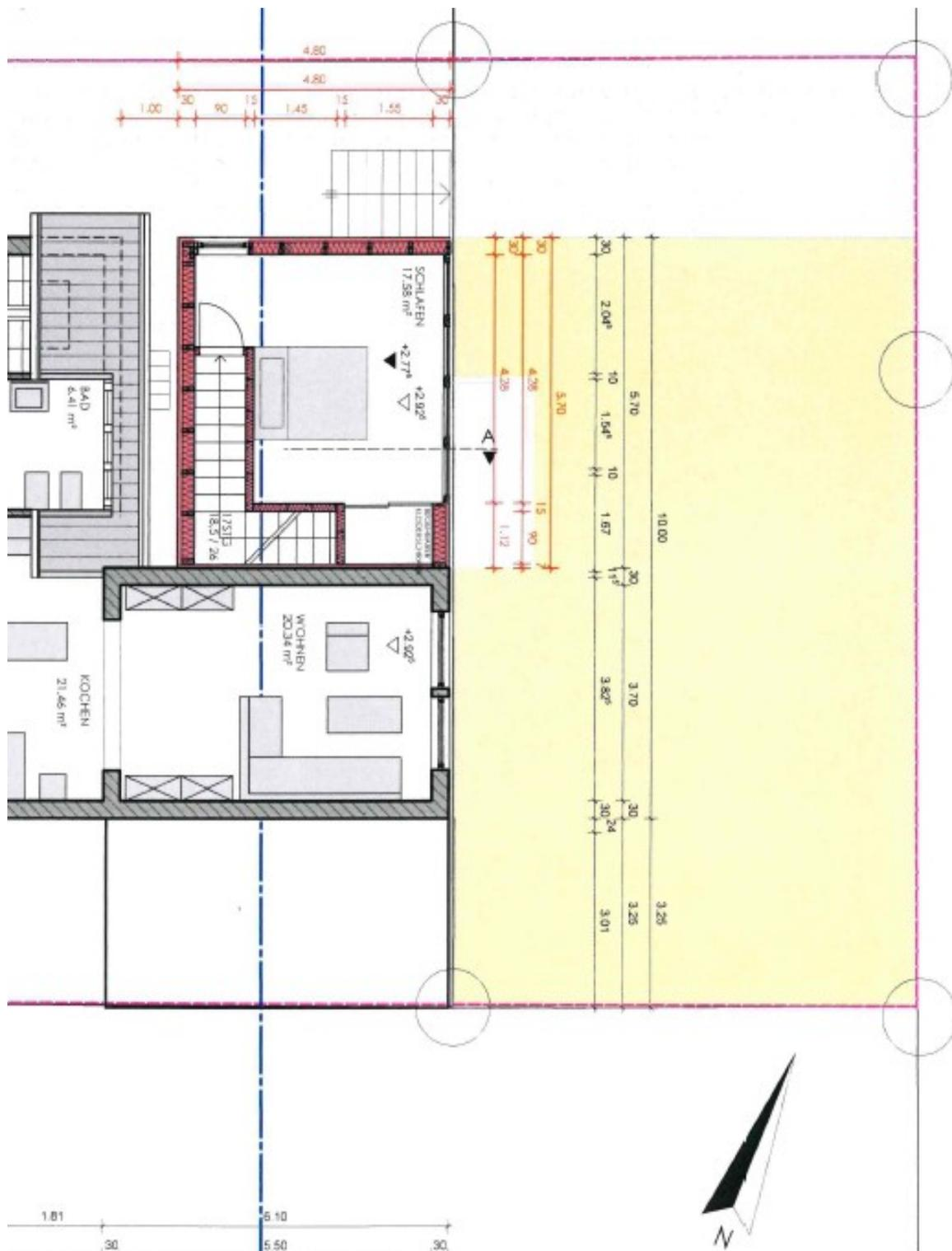
Abb. 2: geplanter rückwärtiger Anbau (rotes Mauerwerk)
