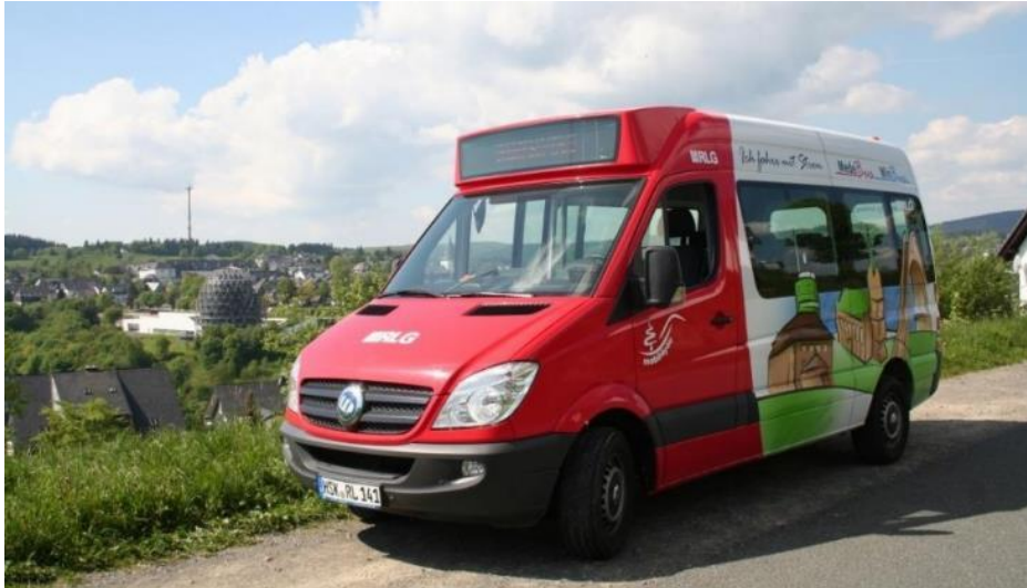
Abbildung 17: Beispiel eines Batterie-Minibusses (Hersteller: German E-Cars, Fahrzeugname: PLANTOS) [10]
