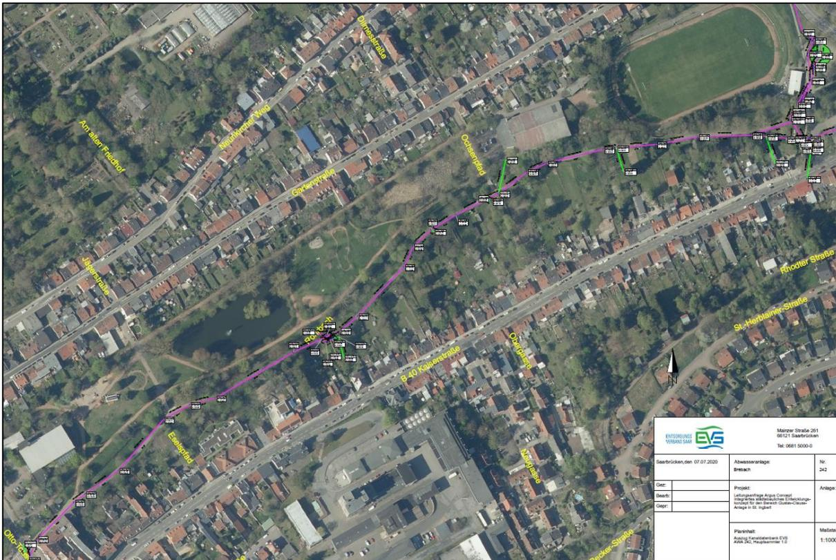
Abbildung 41: Abwasseranlagen des EVS mit Lage der Abwasserleitungen sowie den eingemessenen Schächten (EVS, 2020)
